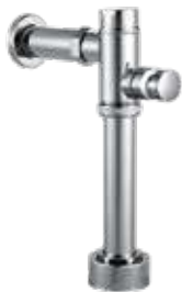
Fluxómetro mecánico para inodoro de 6 litros 2121V23007000 Con botón tubo de descarga en acero inoxidable, descarga directa.
